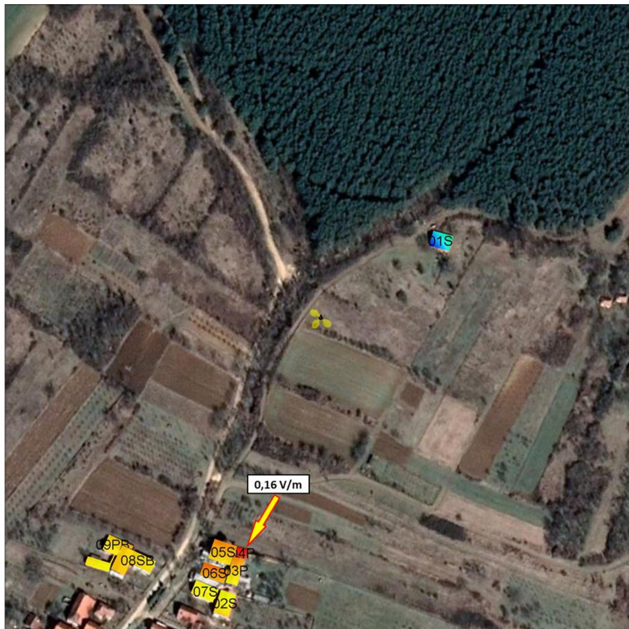
Слика 6.8. Јачина електричног поља унутар објекта када радио-систем UMTS900 оператора Cetin ради максималним капацитетом
