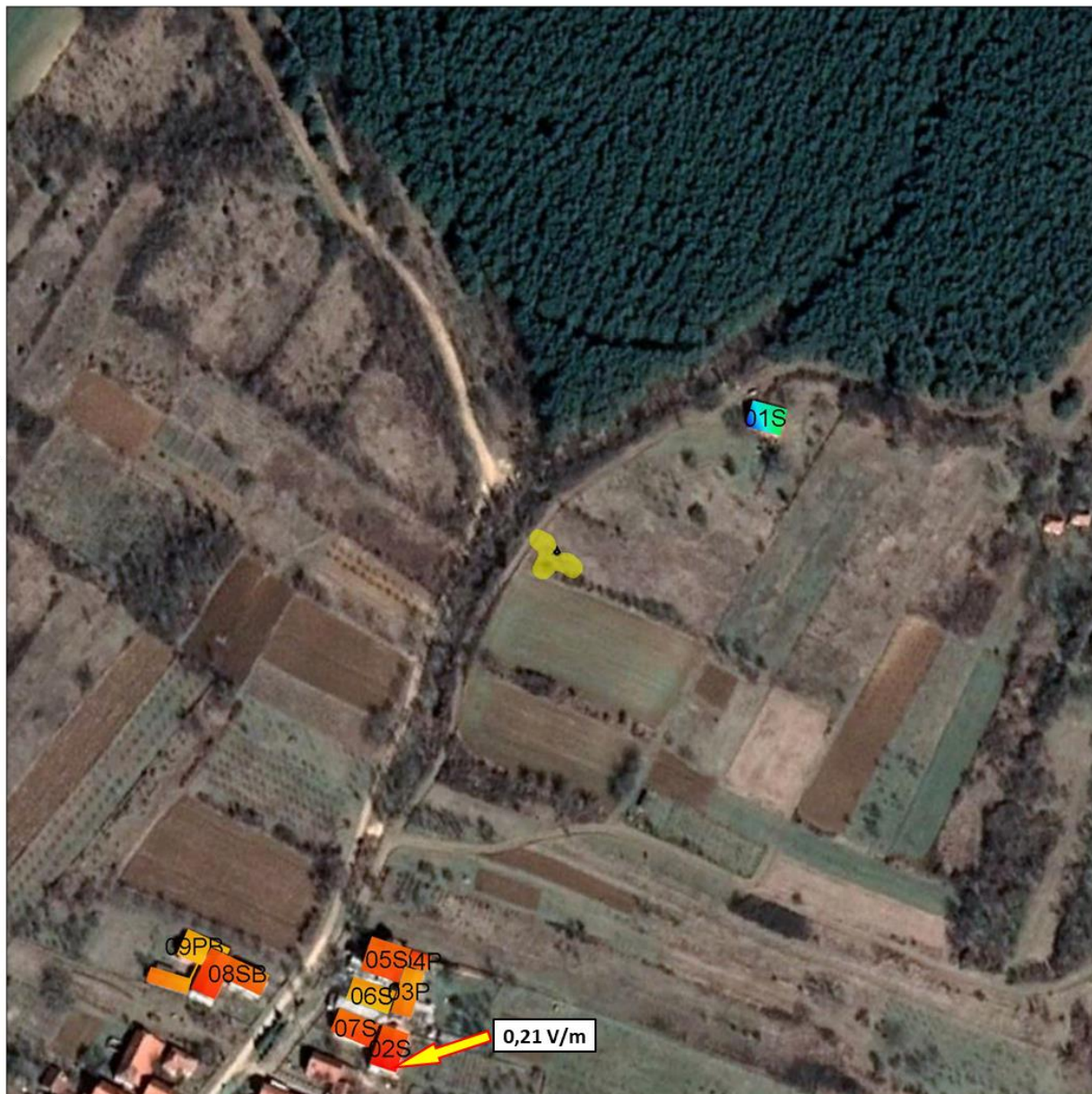
Слика 6.9. Јачина електричног поља унутар објекта када радио-систем LTE800 оператора Cetin ради максималним капацитетом
